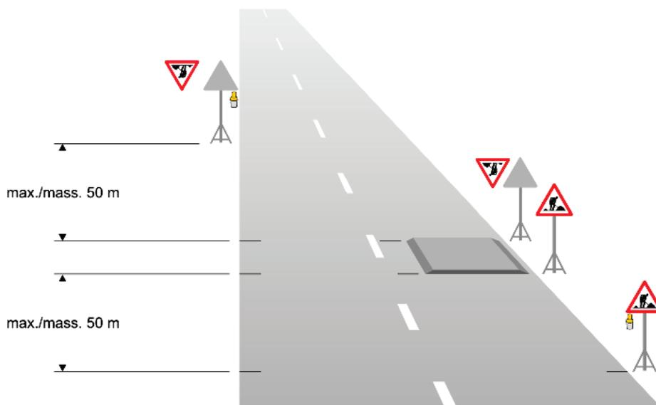
Abbildung 5A aus Norm VSS 40 886:2019-03 «Baustellen, Signalisation von Baustellen auf Haupt- und Nebenstrassen»
